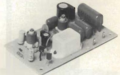
Questo ricevitore in combinazione con il trasmettitore KS 482 consente di avere una fonte sonora ausiliaria all'apparecchio telefonico, facilmente spostabile nell'ambito domestico senza bisogno di fili appositi o antenne.
